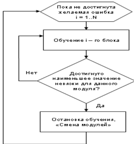
Рис. 2. Обучение нейронной сети с использованием модульного принципа ( N – количество модулей)
